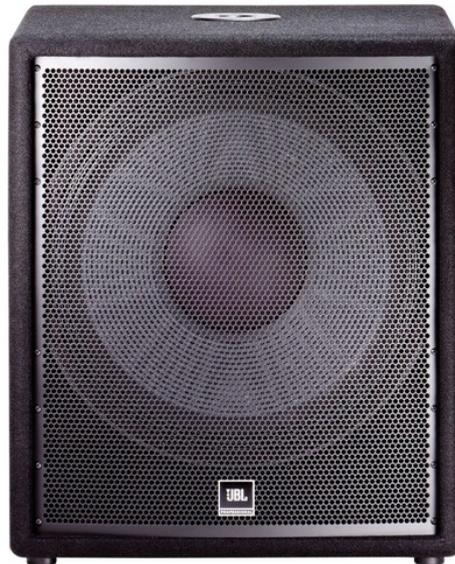
Le subwoofer JRX218S est équipé d'un haut-parleur 46 cm intégré dans un cadre moulé sur un pavillon de 3°. Il est capable de supporter une puissance continue de 350 W et de 1400 W crête. Les programmes de réglages sont disponibles dans le contrôleur de diffusion dbx DriveRack PA+ permettant ainsi d'obtenir du système ses meilleures performances.
